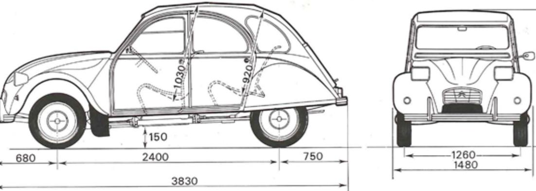
**MOTOR:** 2-cylindret, 4-takt boksertype med luftkøeling. Volumen: 602 cm<sup>3</sup>. Boring: 74 mm.
