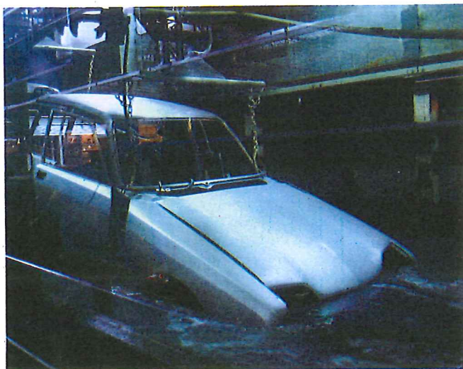
Passage d'une caisse au bain d'électrophorèse.
