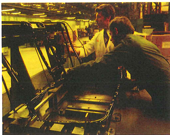
Contrôle de résistance d'une armature de siège.
