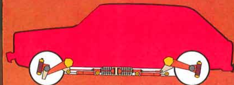
Individuell hjulupphängning. Samverkan mellan fram- och bakhjul med ett långsgående fjäderpaket.
