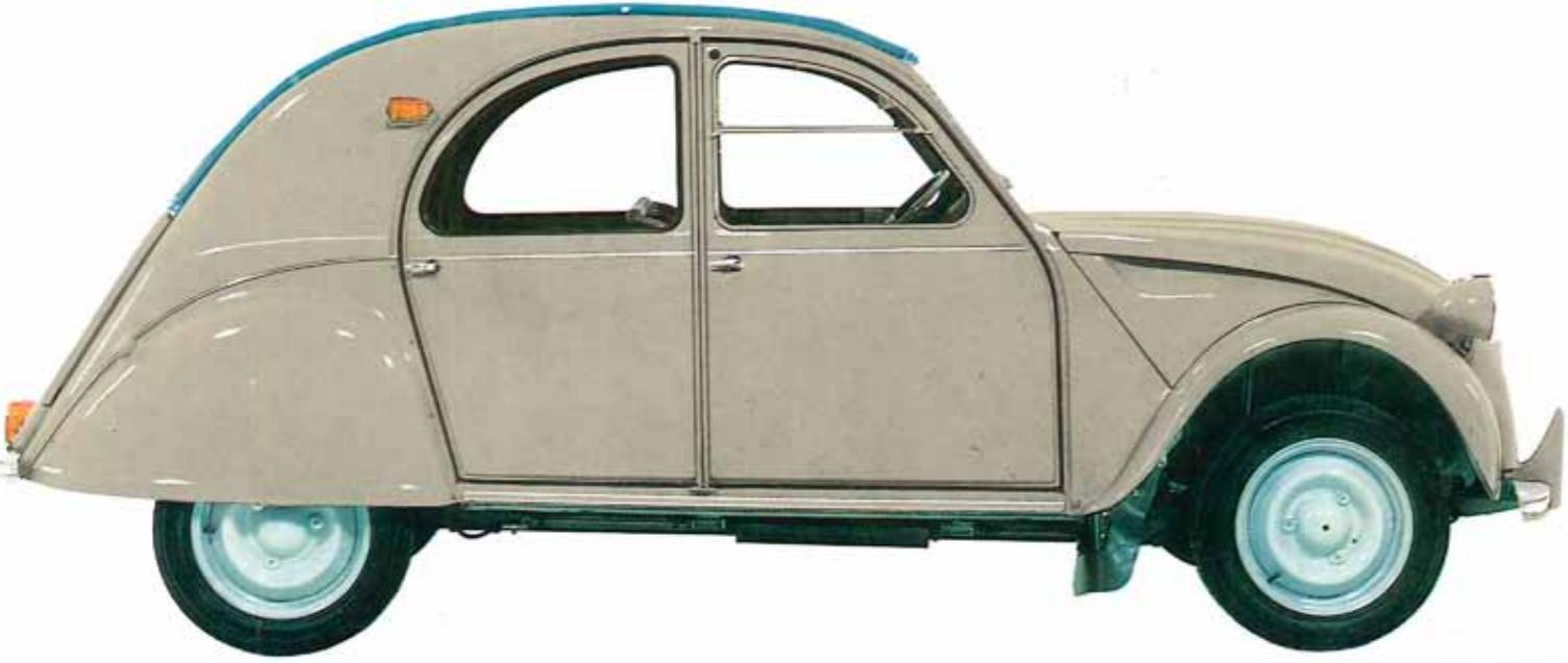
18 hk - 2-cyl. 425 cm<sup>3</sup> motor - bensinsnål 0,5-0,55 lit/mil - centrifugalkoppling - överskådlig instrumentpanel - ställbara strälkastare - 4 färgkombinationer.
