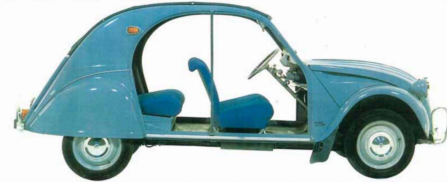
Lyxmodell av B 425 L - specialratt - skjutbart framsäte av typ MI 6 - stötfångare av förkromade rör med gummikutchar - navkapslar.
