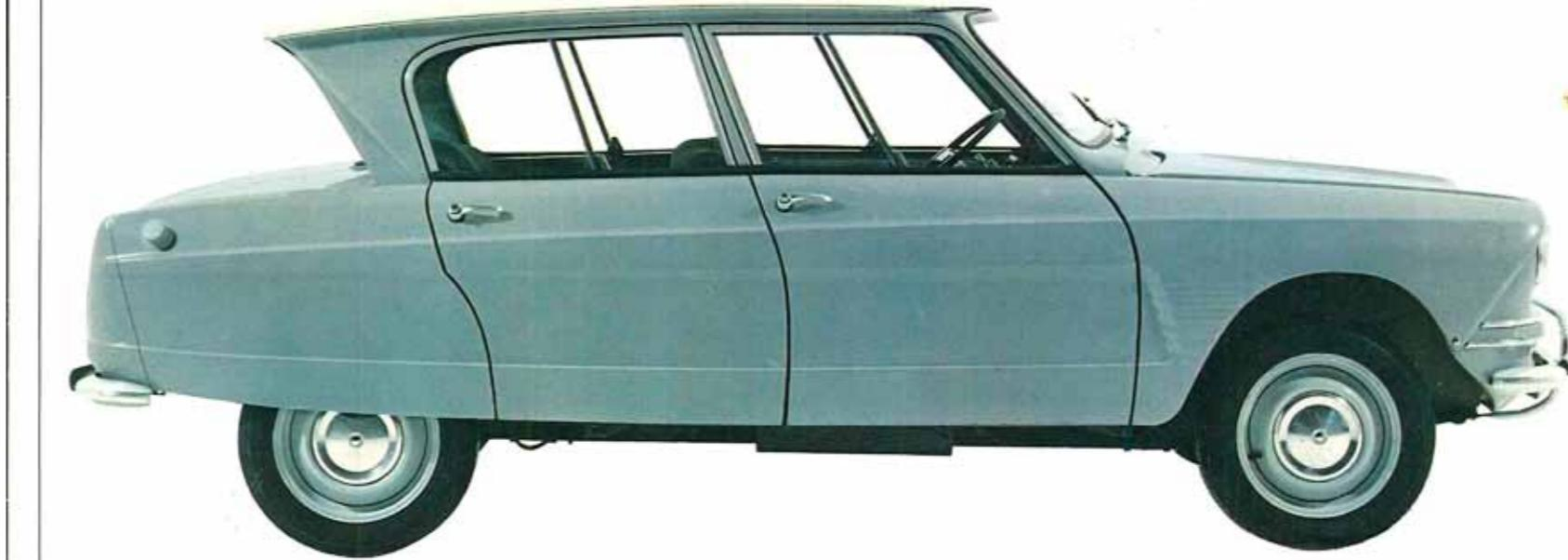
25 hk - 2 cyl. 602 cm<sup>3</sup> motor - 0,65 lit/mil vid 75 km/h - 4-sitsig - förstyvat fjädringssystem med teleskopstötdämpare - skjutbart framsäte - 5 färgkombinationer.
