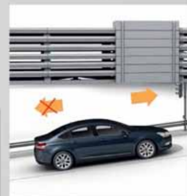
SYSTEMET HILL ASSIST FÖR STARTI SÄMP I BÄCKE HÅLLER AUTOMATISKT BILEN STILLASTÄNDE LÖP TILL CA TVÅ SEKUNDER.
