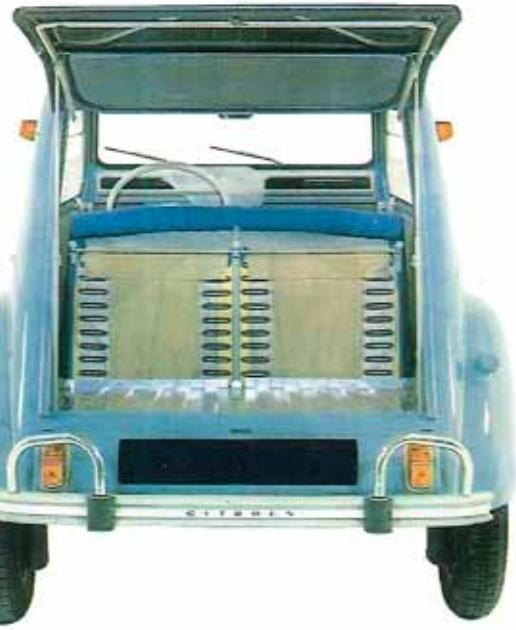
25 hk - 2 cyl. 602 cm<sup>3</sup> motor - 0,65 lit/mil vid 75 km/h - 4-sitsig - förstyvat fjädringssystem med teleskopstötdämpare - skjutbart framsäte - 5 färgkombinationer.
