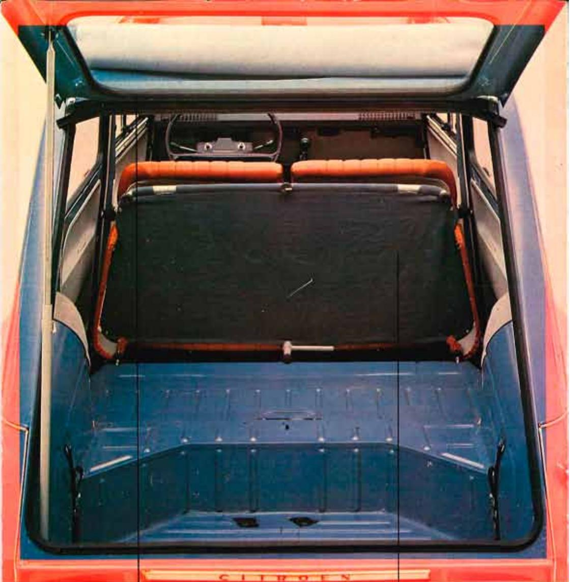
*Grand hayon à lunette incorporée occupant l'arrière de la voiture, de la capote à la plaque de police (2 positions d'ouverture).*
