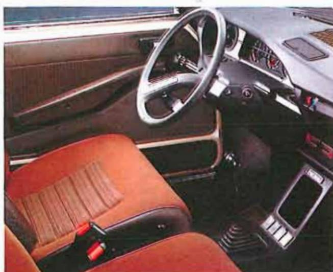
Les sièges sont conçus pour assurer en toutes circonstances le maintien du corps. Ils sont moelleux et épais. La console centrale comprend, outre le levier de changement de vitesse et la commande de hauteur de garde au sol, un vide-poches et un emplacement pour la radio.
