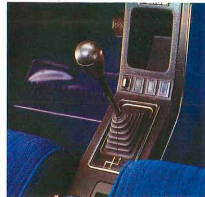
Lorsque l'on veut conduire d'une façon sportive, il est toujours possible de passer les vitesses comme sur une boîte classique. Simplement, il n'est plus besoin de débrayer. Le Cmatic ménage ainsi tous les éléments de la transmission.
