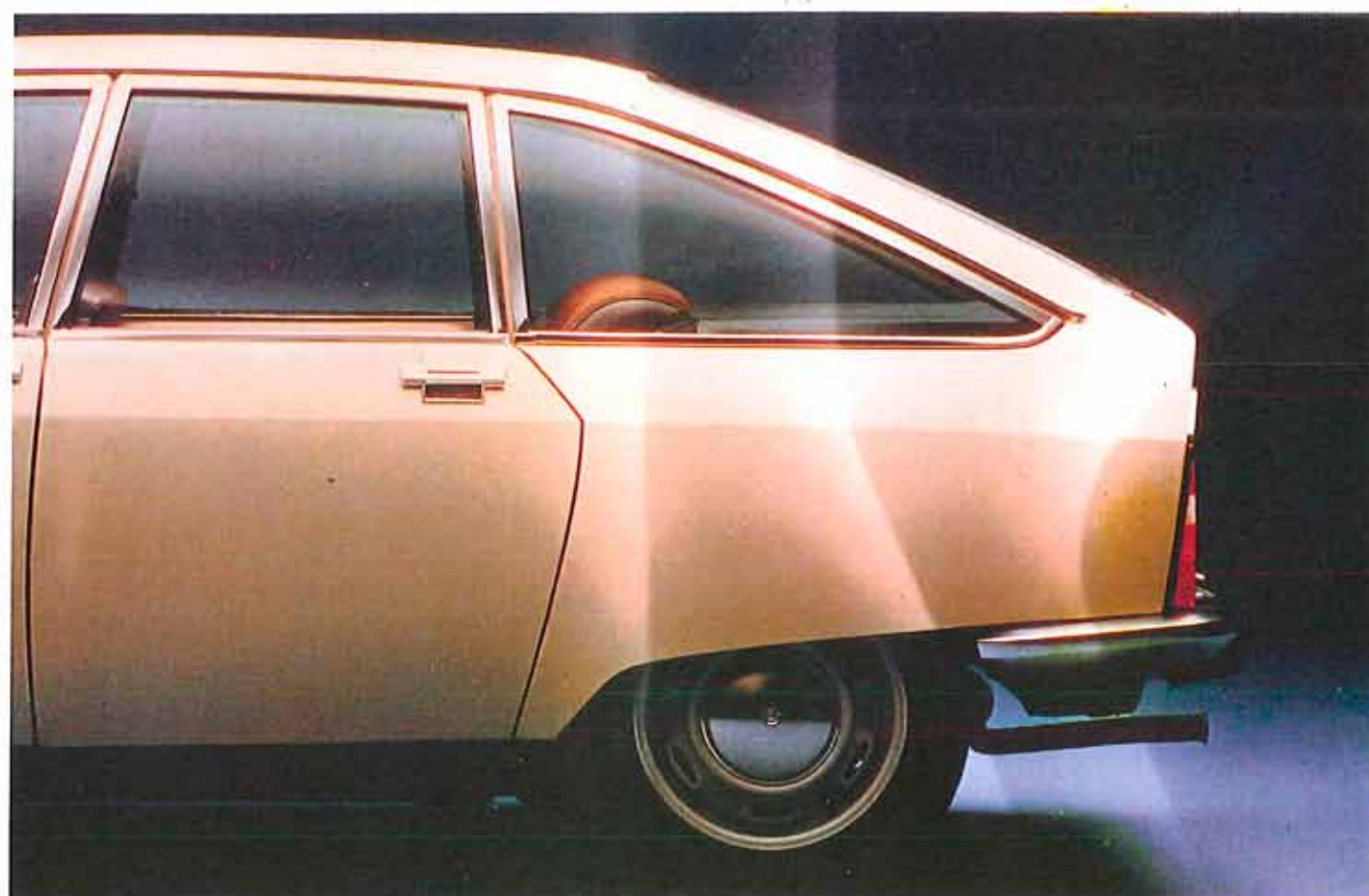
Deformerbara krockzoner runt om på Citroën GS ska absorbera så mycket som möjligt av stötenergin vid en kollision.
