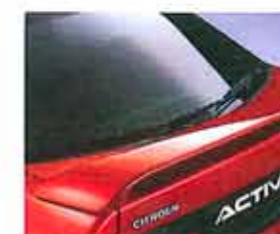
Bättre aerodynamik med spoiler på bakluckan.
