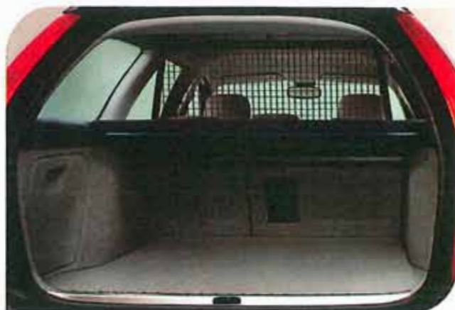
Lastförskjutningsskyddet skyddar de åkande från att skadas av bagaget vid en kraftig inbromsning eller vid en olycka.
