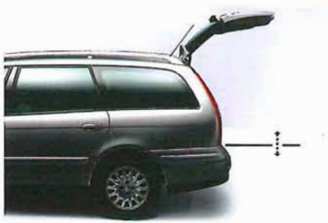
Genom att trycka på en knapp kan du variera lasthöjden med hela 16 centimeter. Max höjd är 653 mm och min höjd är 493 mm.
