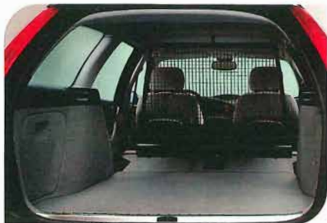
Lastförskjutningsskyddet kan flyttas beroende på om man fällt baksätet eller ej.
