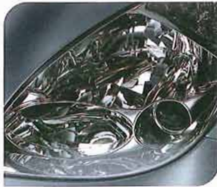
DIMSTRÅLKASTARE På alla Xsara modeller finns dimstrålkastare inbyggda i de vanliga strålkastarna.
