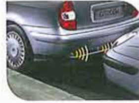
Elektronisk parkeringshjälp: 4 sensorer bak till varnar för eventuella hinder.
