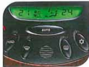
KLIMATANLÄGGNING Den helautomatiska klimatanläggningen har separata regler för höger och vänster sida av kupén. Klimatanläggningen har dessutom en solmätare för att kompensera effekten av solstrålning i passagerarutrymmet.
