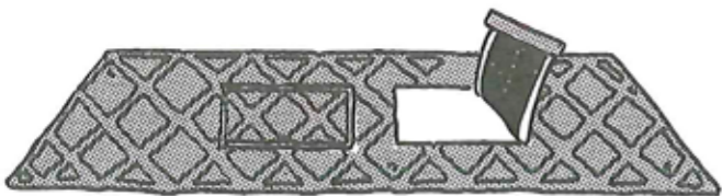
KYLARSKYDD för GS, med reglerbar lucka, kylarskydd skall sättas på då temperaturen understiger +10° C.
