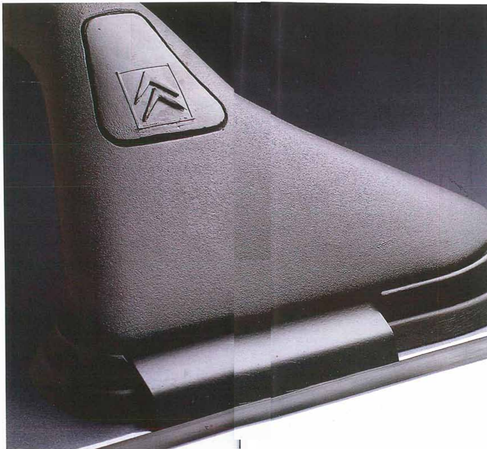
"AEROSTYL" LASTHÅLLARE Aerodynamisk utformning. Stöd av alumi- nium, stålrör med halk- skyddat hölje. Monteras i för- borrade hål i karossen. Maxlast 75 kg. ZC 9867 883U
