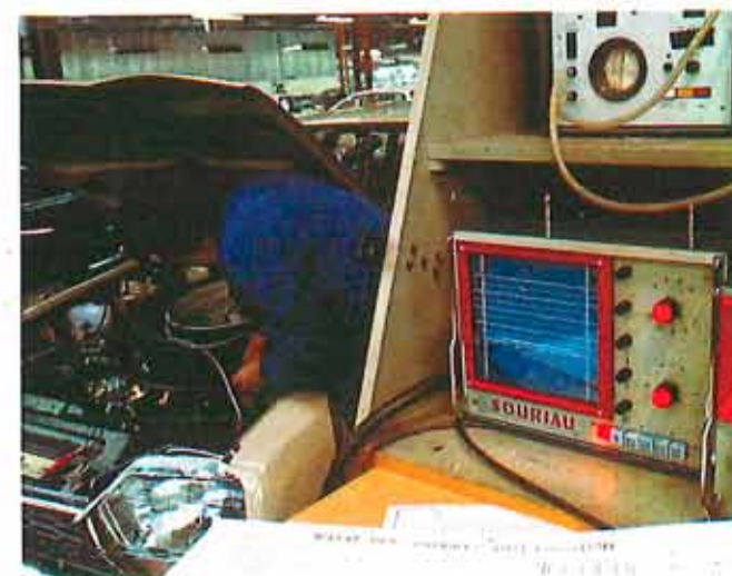
Contrôle de dépollution du moteur et réglages des taux d'oxyde de carbone et de gaz carbonique.
