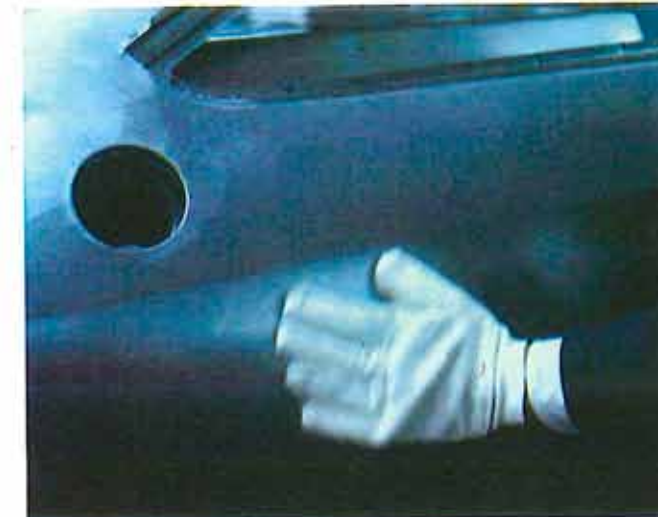
Finition carrosserie à la "paluche" et préparation de la peinture
