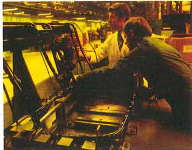
Contrôle de résistance d'une armature de siège.
