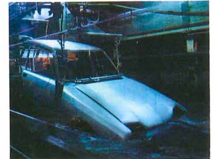
Passage d'une caisse au bain d'électrophorèse.
