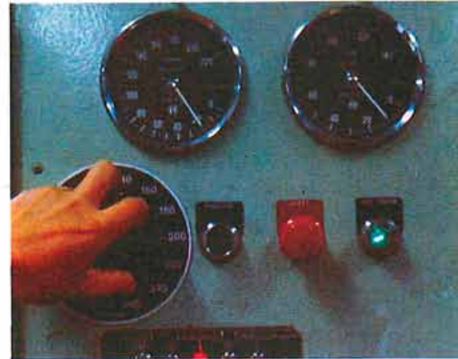
Contrôle de fonctionnement d'un maître-cylindre de frein.
