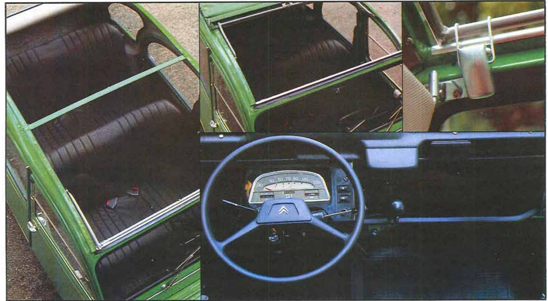
2 CV 6 er en noget kraftigere version med motor på 602 cm 3 og tophastighed på 110 km/t - men ellers næsten identisk med 2 CV 4.
